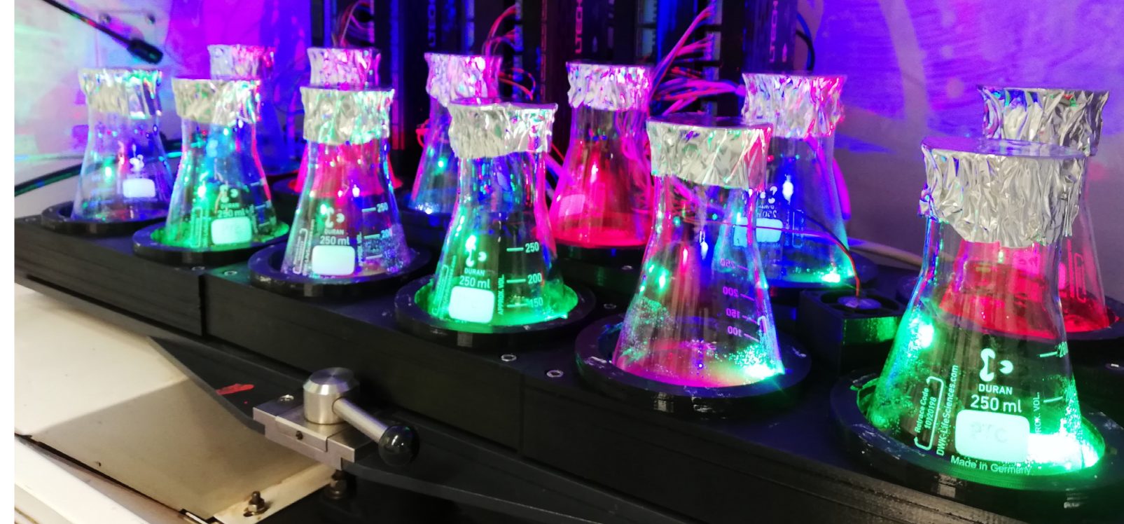
Das LEDitSHAKE-System: 12 individuell beleuchtete Erlenmeyerkolben im Schüttelinkubator.
