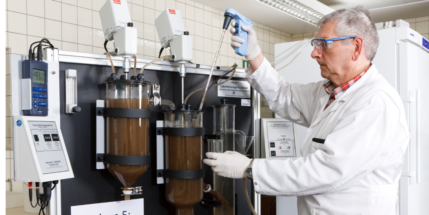
Verhalten von Silbernanopartikeln in der Kläranlage und Adsorption an den Klärschlamm.
