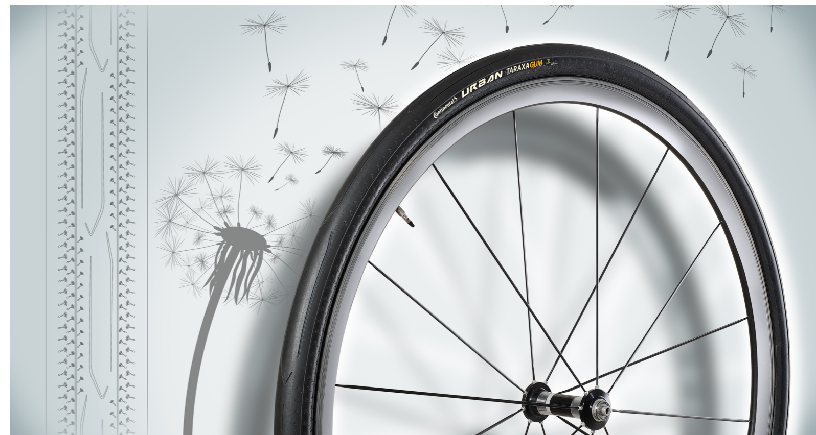
Der Urban Taraxagum von Continental ist der erste in Serie gefertigte Fahrradreifen aus Löwenzahnkautschuk.
